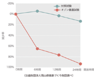
低濃度オゾンガスによる殺菌効果テスト (弊社製品ビコレット使用) 黄色ブドウ菌の減少率の変化
